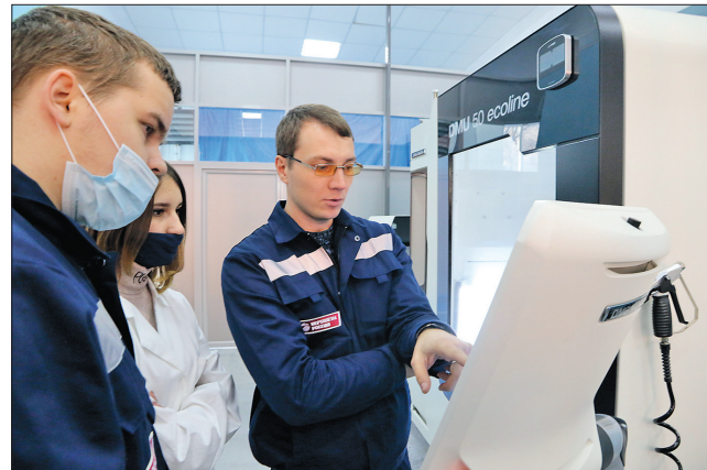
Главный объект мастерской многоосевой обработки на станках с ЧПУ – пятикоординатный фрезерный центр.
