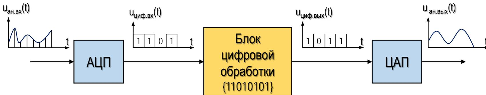
**Рис. 1.8. Функциональная схема системы цифровой обработки сигналов**
